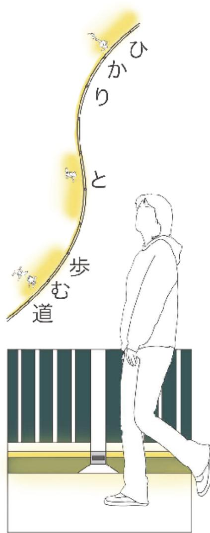
手摺に取り付けられる LED ライン照明。支柱部分に人感センサーを設置し、人が通ると支柱両側のライトが3秒間点灯する。(ひと区間3m、歩く速度…1.0~1.5m/s と想定)
